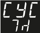
Después de confirmar el ajuste de los setpoint de refrigeración y calefacción, se mostrará el mensaje [CYC] en el display, permitiendo el ajuste del tipo de ciclo, de acuerdo con las siguientes opciones:
