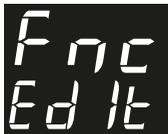
Ingrese al menú de configuraciones avanzadas presionando la tecla SET por 4 segundos hasta aparecer [Fnc]. Enseguida aparecerá [CoD], y entonces presione nuevamente la tecla SET (toque corto). Utilice las teclas < o > para ingresar el código de acceso 123, y en seguida presione nuevamente la tecla SET (toque corto).
