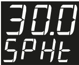
El display mantendrá el valor de setpoint de calefacción destellando mientras que se está ajustando, respetando los límites definidos en [F05] - Valor mínimo permitido para configurar el setpoint de calefacción y [F06] - Valor máximo permitido para configurar el setpoint de refrigeración. Se debe ajustar el valor utilizando las teclas < o > y confirmar el ajuste deseado con un toque corto en la tecla SET.
