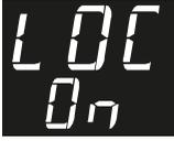
Para habilitar/deshabilitar el bloqueo de funciones se deben mantener presionadas las teclas < y > por el tiempo configurado en el parámetro [F18] - Tiempo para bloqueo de funciones. Con esta configuración activada, los parámetros no pueden ser alterados, pero pueden ser visualizados. Los parámetros que estarán disponibles para su ajuste, cuando es activado el bloqueo, son definidos por el parámetro [F17] - Bloqueo de Funciones.
