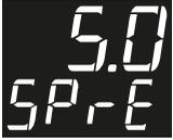
El display mantendrá el valor de setpoint de refrigeración destellando mientras que se está ajustando, respetando los límites definidos en [F02] - Valor mínimo permitido para configurar el setpoint de refrigeración y [F03] - Valor máximo permitido para configurar el setpoint de refrigeración. Se debe ajustar el valor utilizando las teclas < o > y confirmar el ajuste deseado con un toque corto en la tecla SET.
